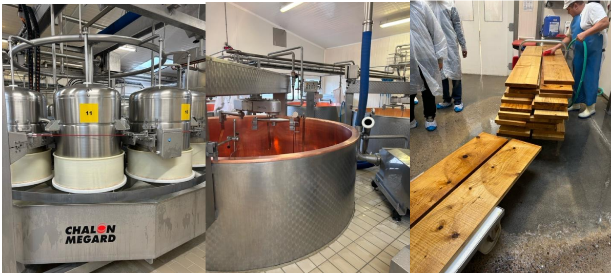
Machine qui moule et presse le comté Cuve en cuivre pour chauffer le lait
