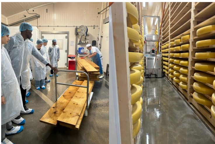
Cave d'affinage avec un robot qui frotte et retourne les comtés
